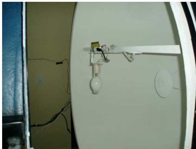
Figure 12 : Lampe vapeur de mercure de 175 Watts en essai en sphère 38
