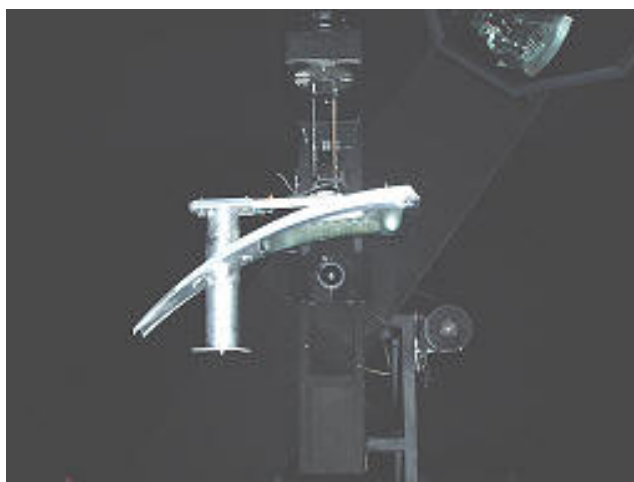
Figure 2 : Goniophotomètre à miroir
