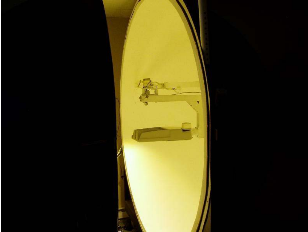
Figure 1 : Mesure d'un luminaire en sphère intégratrice
